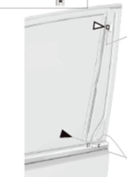
1. 从窗框边缘拉出前门框外装饰件 (A) 上边缘时, 用多用途刀割开双面胶带 (B), 然后从门框拆下前门框外装饰件。
